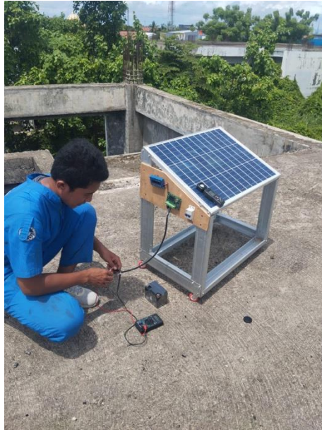
Gambar 2. Pengukuran Kinerja battery charger
