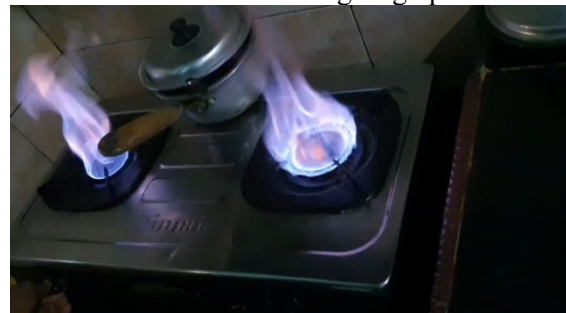
Gambar 7. Nyala Api Biru Stabil pada Kompor Biogas sebagai Indikator Kandungan Metana yang Memadai
