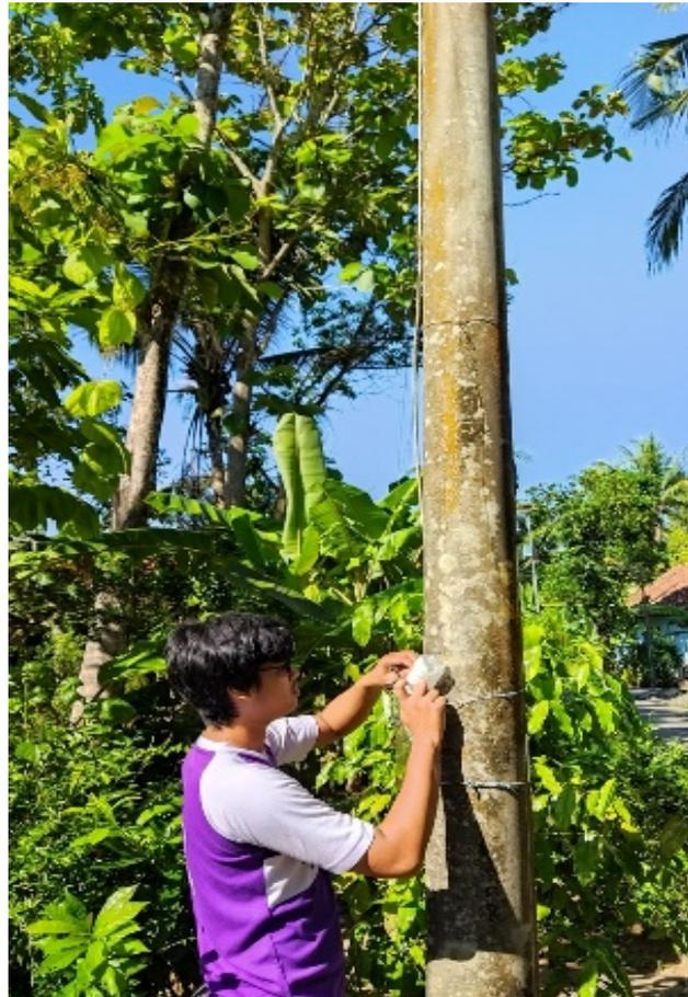
Gambar 10. Pemasangan modul kendali pada uji lapangan 2
