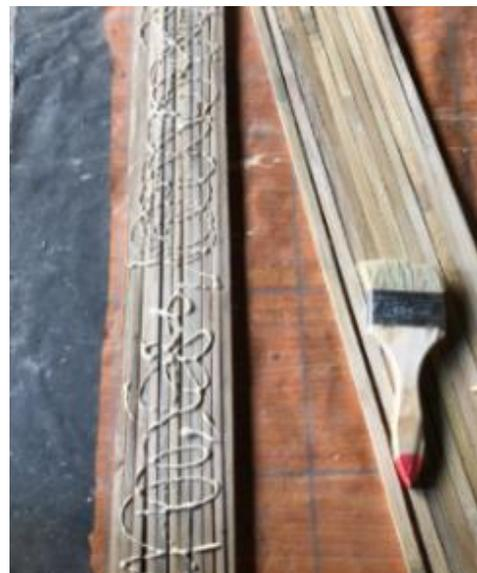
**Gambar 2.** Proses Pengeleman Antar Bilah Bambu
