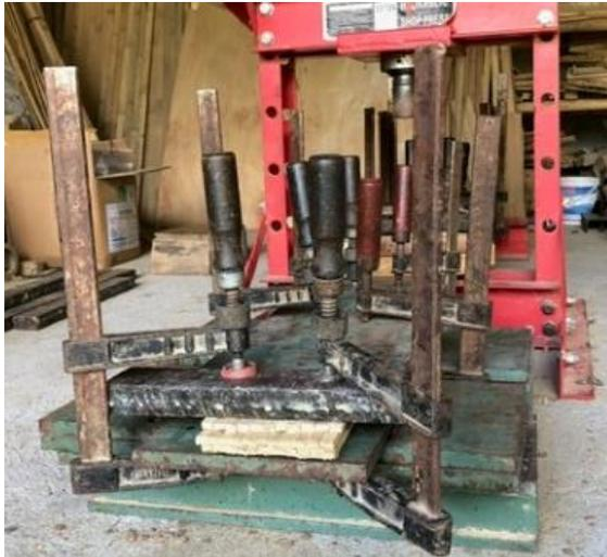
**Gambar 3.** Proses Pengkleman Antar Lapisan Laminasi
