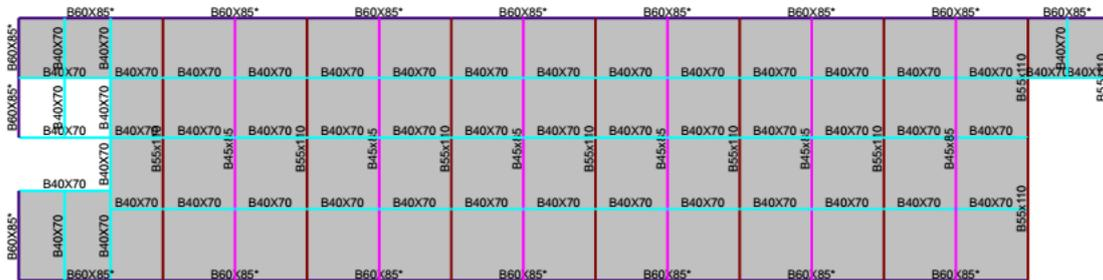
Gambar 15. Denah ukuran balok tipikal
